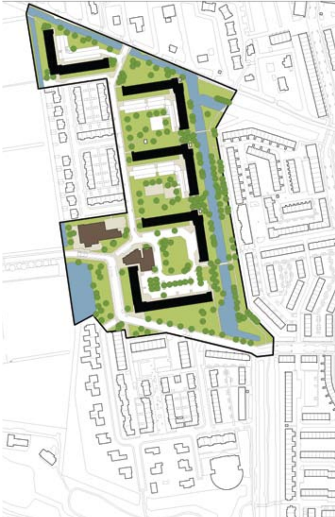
overzichtskartaal 1:5000 - hakenverkeveling van galerijflats van 4 en 6 lagen rondom openbare groene tussenhoven. - winkels en school bij de entree van de wijk
